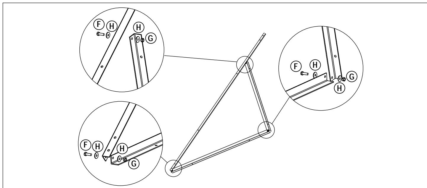
**DE****Montage der Verbindungsplatten des Kollektors**
