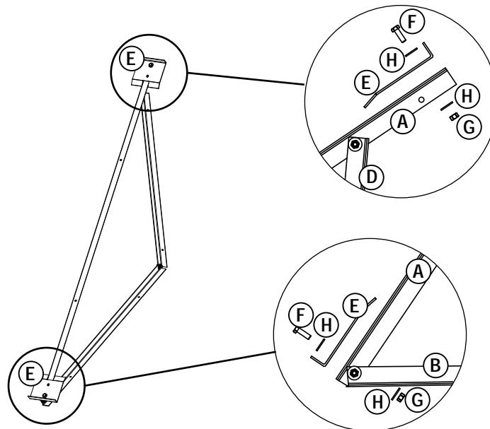
**Montage des Rahmens und Befestigung am Boden**
