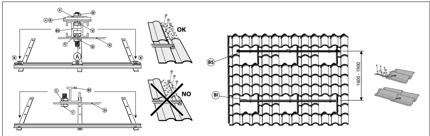
Posizionare i due raccordi idraulici di giunzione sui tubi nella parte interna della schiera e bloccarli serrando leggermente. Posizionare il secondo collettore e farlo scorrere contro l'altro fino a che i tubi vanno a battuta nei raccordi idraulici di giunzione. Posizionare la staffa di giunzione 50x66 (A) in maniera tale che blocchi il bordo dei due collettori, quindi eseguire il fissaggio della staffa esterna (S) sul bordo del pannello non ancora bloccato.
