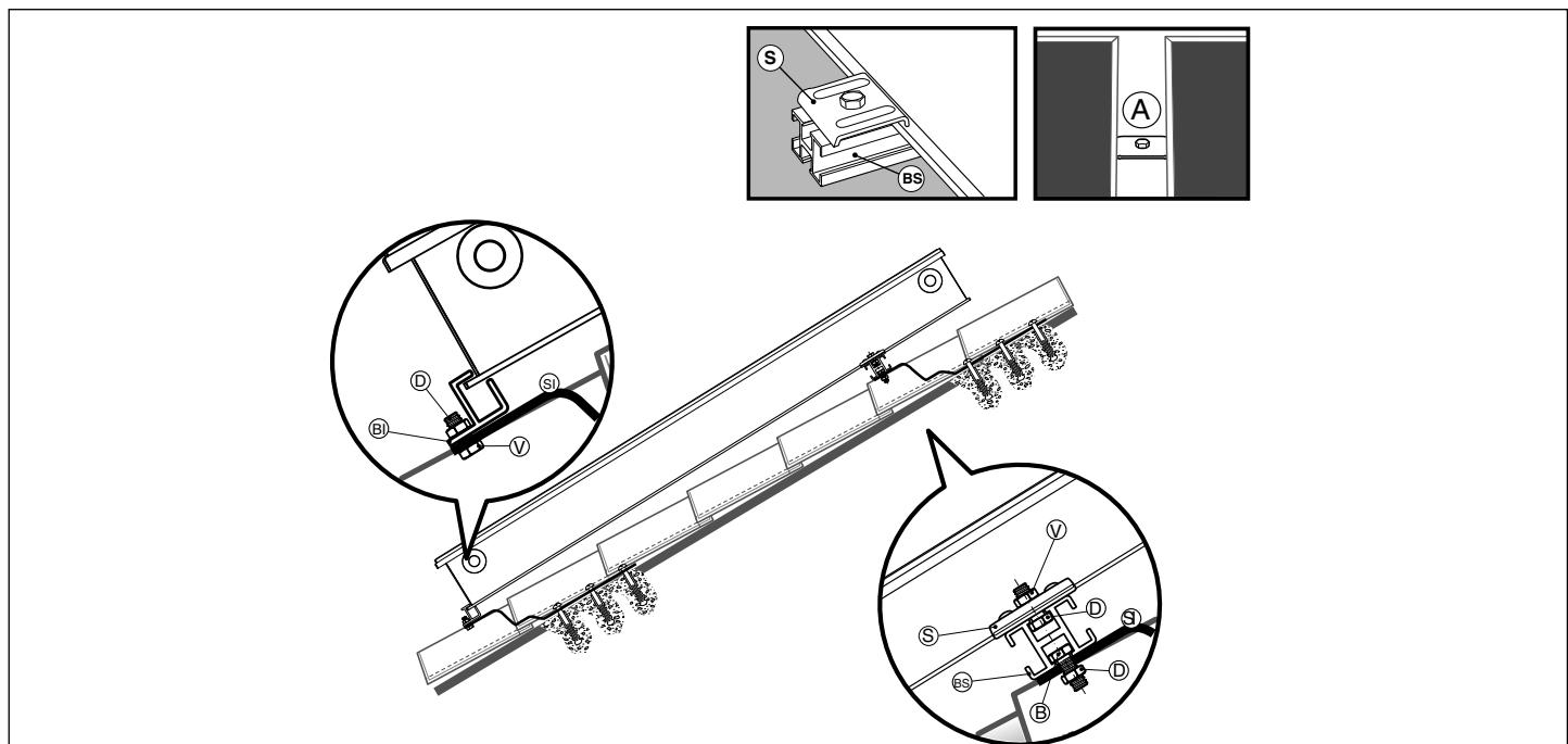
**Attenzione! Nel caso di montaggio integrato nel tetto sono possibili danni alla struttura del tetto a causa della mancanza di camera d'aria!**
