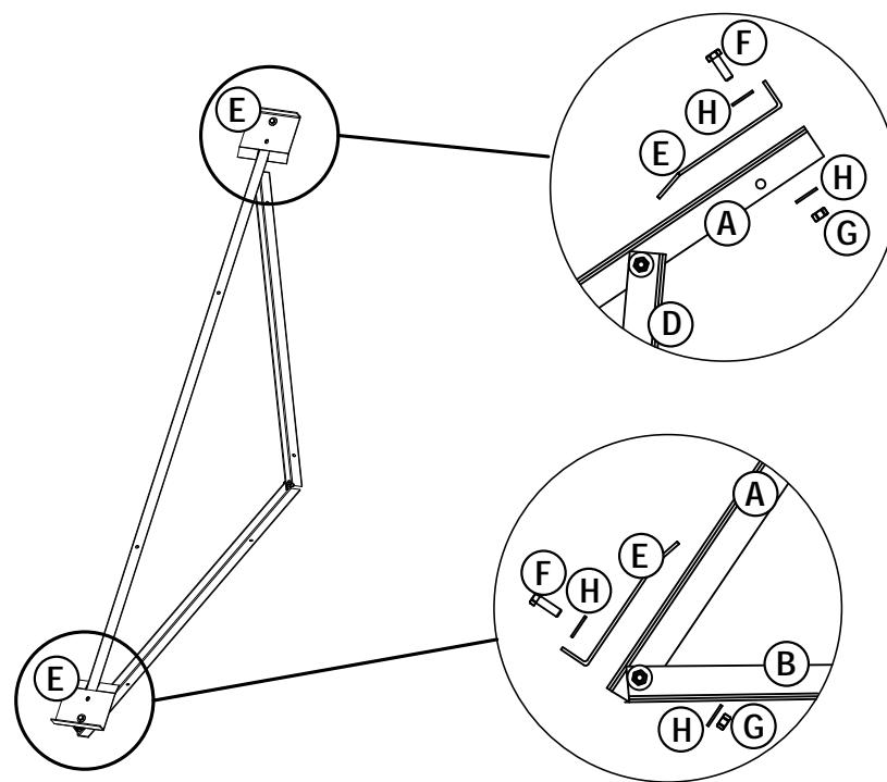
**Montaggio del telaio e fissaggio al suolo**
