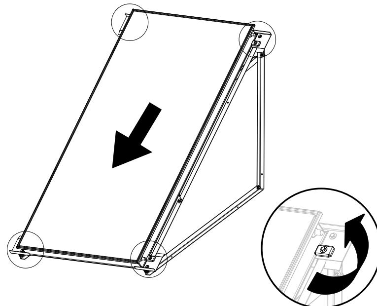
**DE****Installation am Boden oder auf dem Flachdach**
