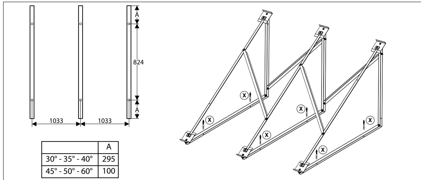
**Dimensioni schiera collettori e predisposizione per fissaggio a tetto inclinato**
